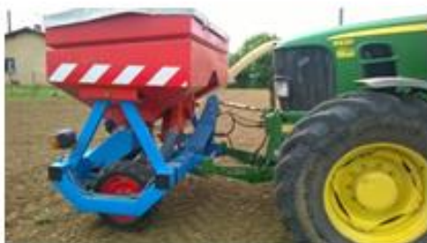
Semis des féveroles avec le localisateur d'engrais solide (secteur L'Isle Jourdain) – 32
