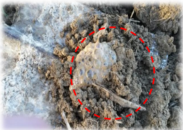
Test d'effervescence (sol argileux) Avec quelques gouttes d'acide chlorhydrique HCL
