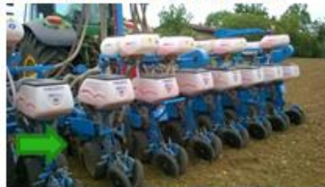
Semis des féveroles avec le localisateur d'engrais solide (secteur L'Isle Jourdain) – 32
